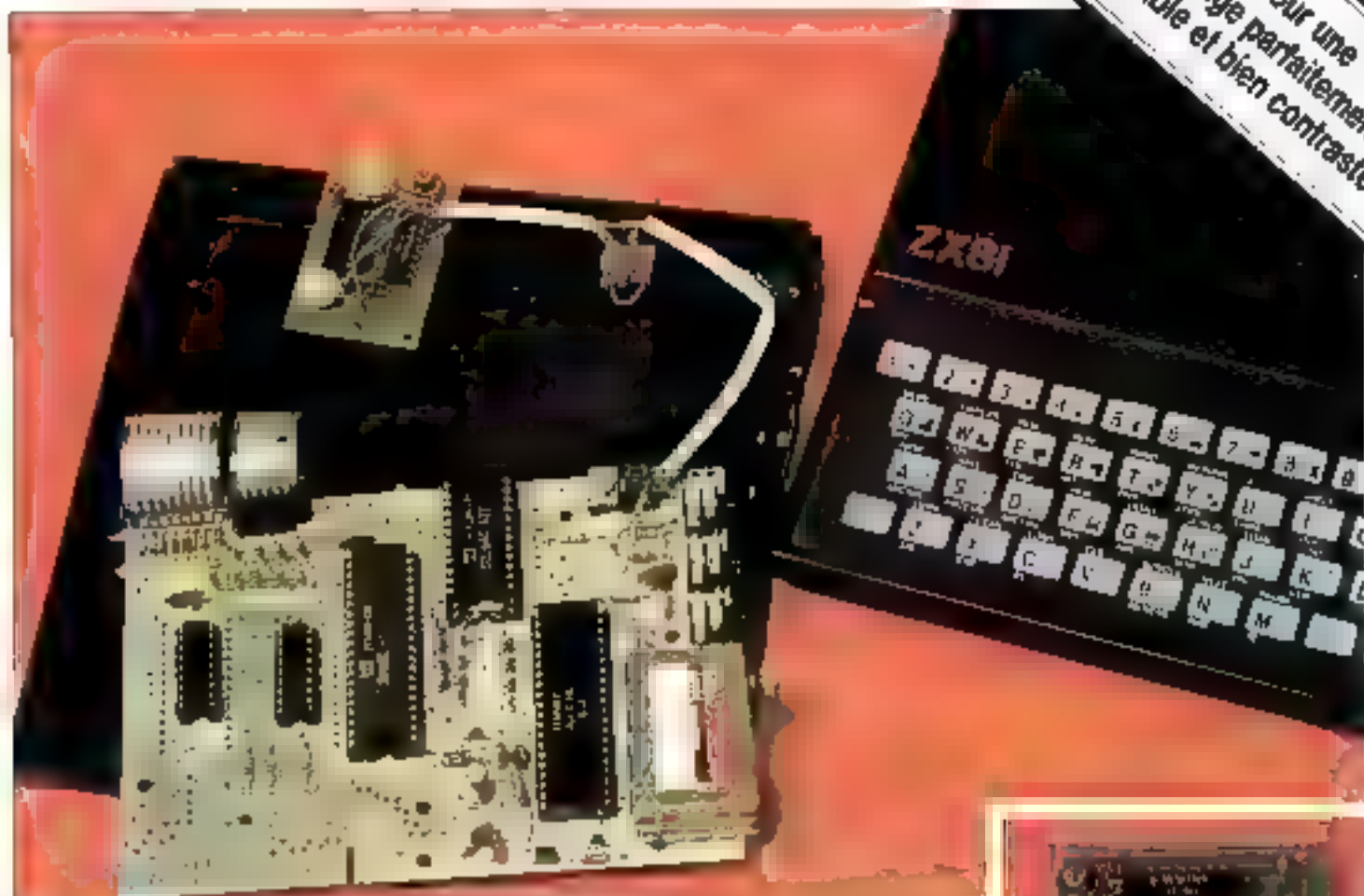
Le module d'inversion vidéo s'intègre dans le boîtier du ZX 81.
